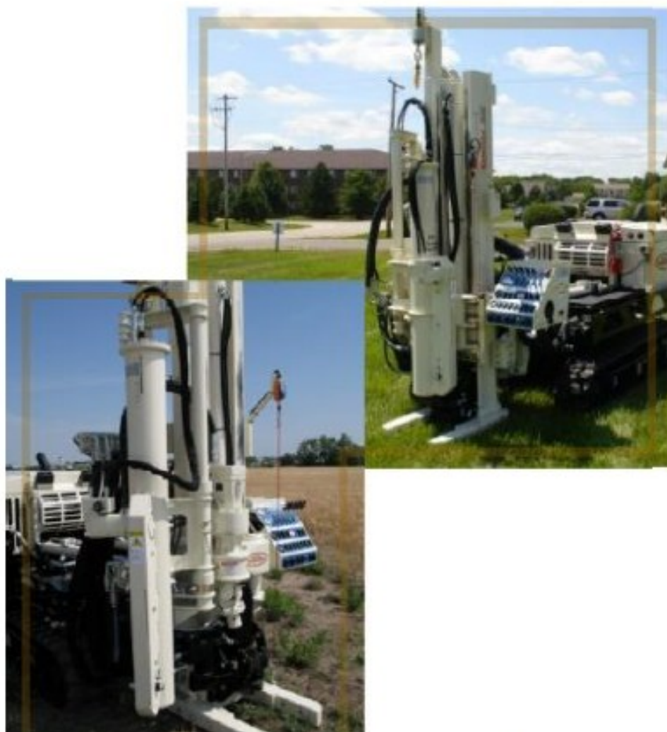
Figura 4 – Sondagem mecanizada (Fonte: Aragon Perfurações e Sondagens)
