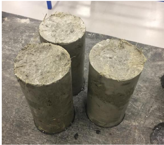
Figura 17 - Moldes com fibra (Fonte: Autor, Centro Tecnológico USF).
