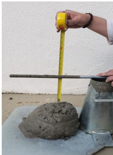
Figura 13 - Teste sem adição de fibra (Fonte: Autor, Centro Tecnológico USF).
