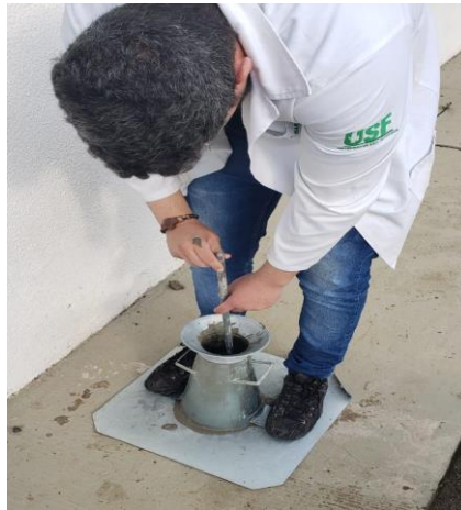
Figura 12 - Slump da mistura obtida entre concreto e fibra (Fonte: Autor, Centro Tecnológico USF).
