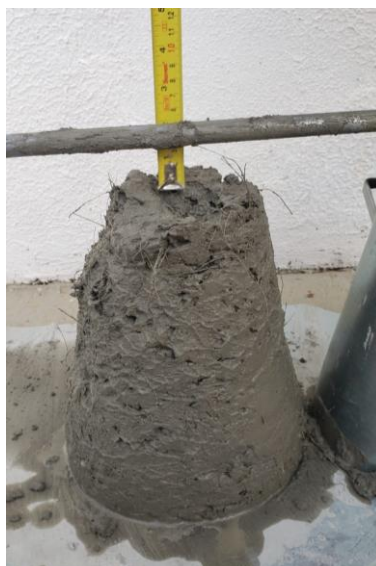
Figura 14 - Teste com adição de fibra (Fonte: Autor, Centro Tecnológico USF).
