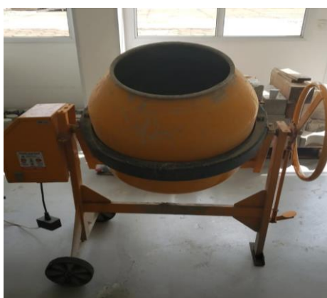
Figura 10 - Betoneira utilizada no processo de mistura (Fonte: Autor, Centro Tecnológico USF).
