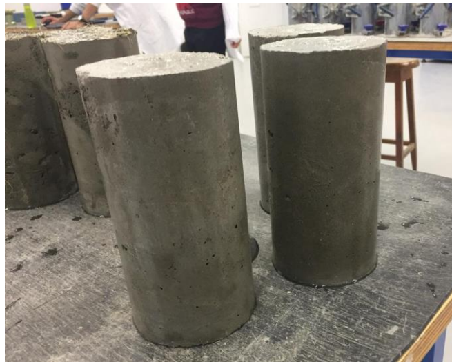
Figura 18 - Moldes com traço tradicional (Fonte: Autor, Centro Tecnológico USF).
