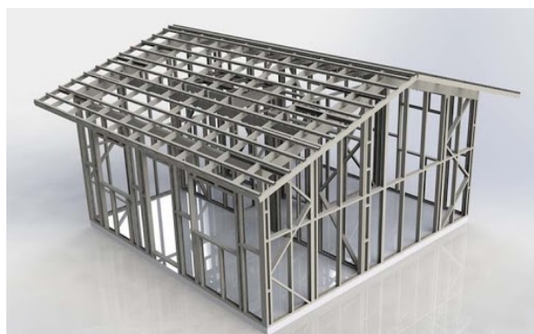
Figura 6 – Estrutura de Steel Frame (Fonte: http://www.solaradrywallbh.com.br/blog/afinal-e-seguro-construir-em-steel-frame/ ).
