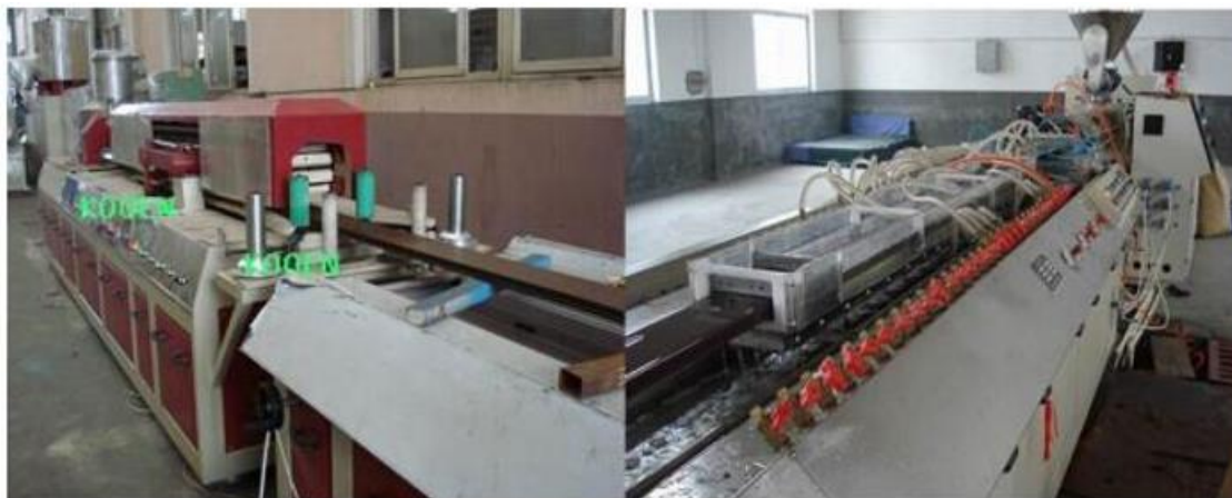
Figura 04 – Processo de fabricação da madeira plástica por extrusão contínua
