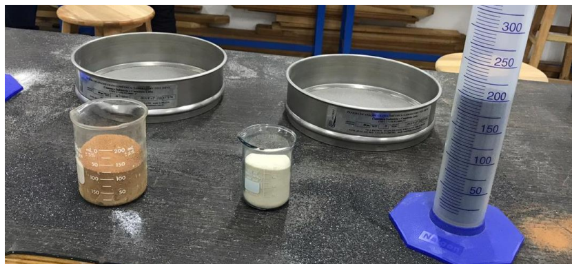
Figura 2 – Materiais utilizados: béquer's de vidro; proveta graduada; peneiras de malhas 30 e 50; e os materiais (Solo, Quartzo e Ferro respectivamente).
