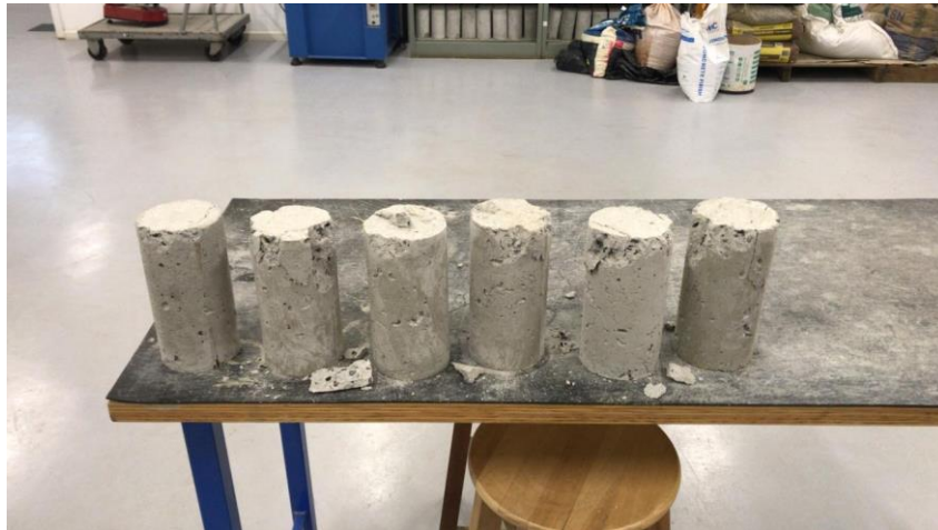
FIGURA 7 – Corpos de prova rompidos do traço 02 Fonte: Autores, CT USF Bragança Paulista, 2020.
