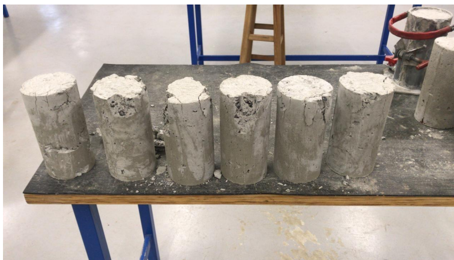
FIGURA 6 – Corpos de provas rompidos do traço 01
