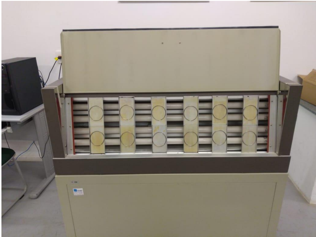
Fonte: Próprio autor Figura 19 – Amostras de 74mmx150mm na câmara UV,
