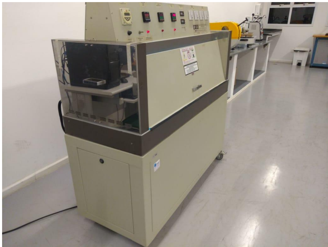
Figura 19 – Câmara de envelhecimento acelerado por luz UV.
