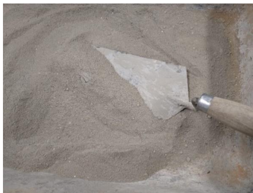
Figura 6 - Mistura cimento e areia (Fonte: Autor).
