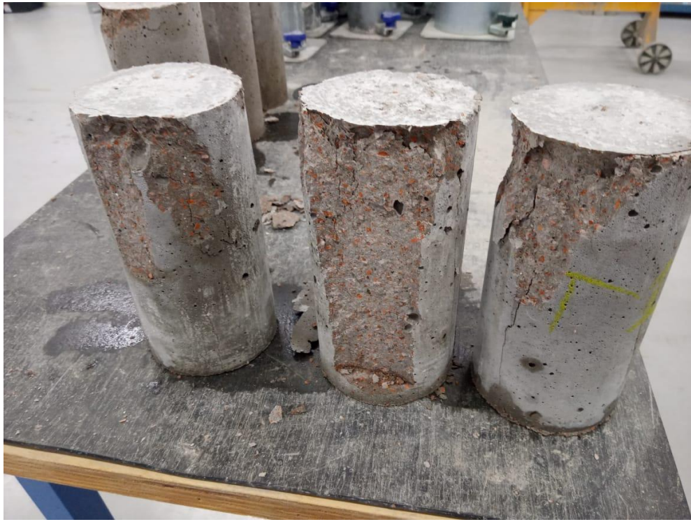
Figura 14 – Amostras do traço 1 de 7 dias após a ruptura. (Fonte: Próprio autor)
