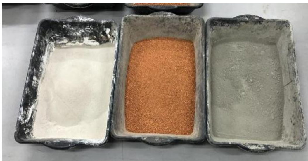
Figura 9 - Traço 02, areia reciclada, cimento e cerâmica vermelha. (Fonte: Próprio autor)
