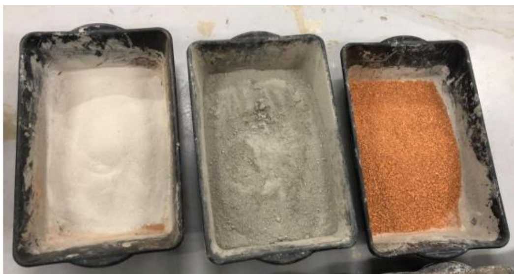
Figura 8 - Traço 01, areia reciclada, cimento e cerâmica vermelha. (Fonte: Próprio autor)
