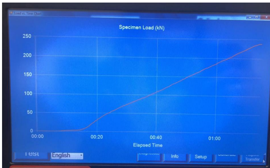
Figura 18 – Gráfico fornecido pela prensa. (Fonte: Próprio autor)
