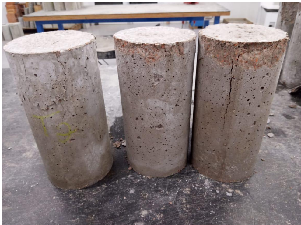
Figura 15 – Amostras do traço 2 de 7 dias após a ruptura. (Fonte: Próprio autor)
