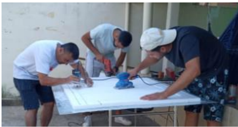
Figura 18 - Realização dos rebaixas (Fonte: Autor).
